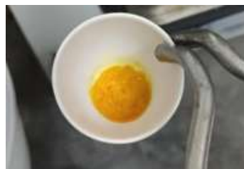
Gambar 2. Residu sampel keju nabati setelah proses pengujian kadar air dengan metode oven
