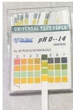
Gambar 4. Pembacaan Nilai pH dengan Kertas Indikator pH
