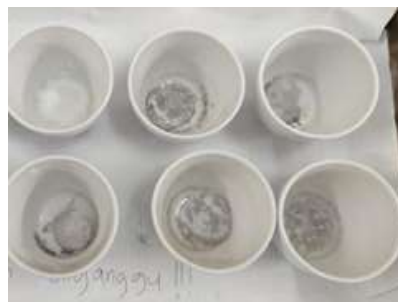
Gambar 3. Residu sampel keju nabati setelah proses pengujian kadar abu dengan metode furnace
