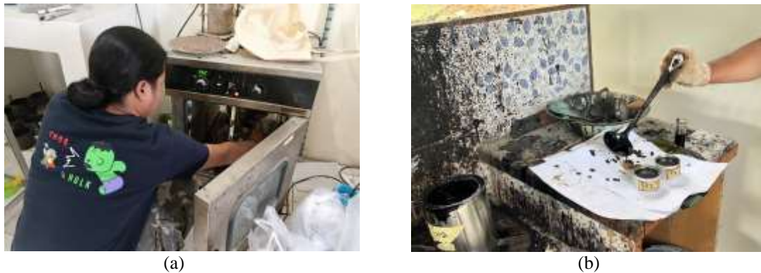
Gambar 11: (a) Sampel Bitumen/Aspal (b) Uji Kehilangan Berat Aspal
