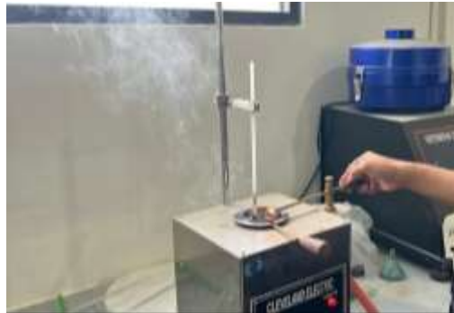
Gambar 6: Pengujian Titik Nyala dan Titik Bakar dengan alat Cleveland Open Cup
