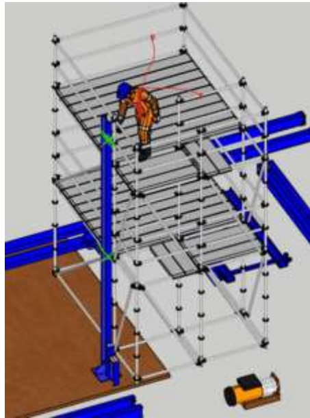
Gambar 6: Pengamanan Sementara Kolom K2
