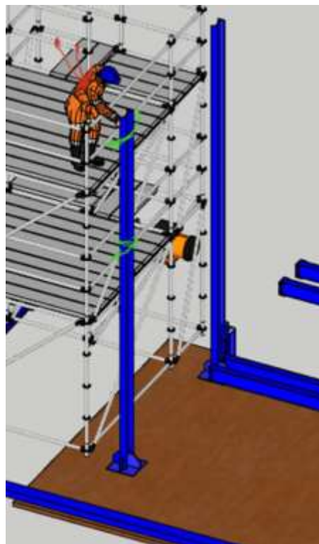
Gambar 9: Pengamanan Kolom Depan K3 dan K4
