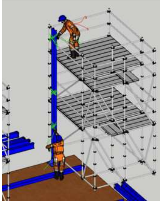
Gambar 4: Pengamanan Sementara Kolom K1
