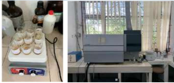
Gambar 1: Proses Destruksi dan Analisis As menggunakan ICP-OES
