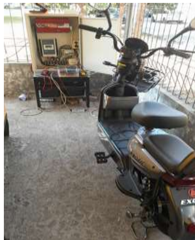
Gambar 4. Pengujian pengisian baterai sepeda listrik pada PLTS off-grid
