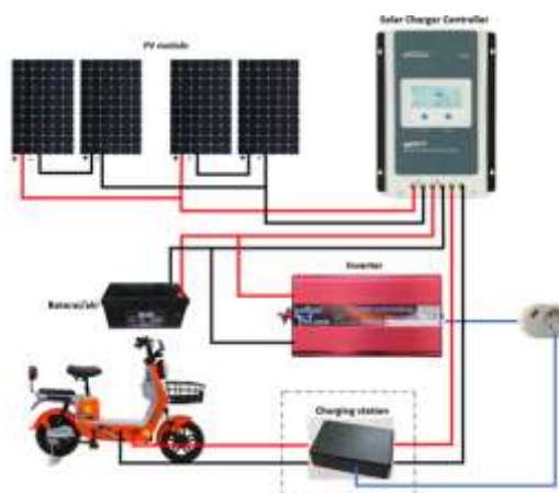
Gambar 2. Sistem PLTS pengisian baterai sepeda listrik
