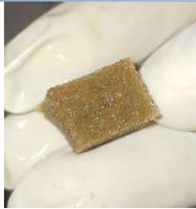
Gambar 1. Media PUF dan PUF-PVA setelah seeding
