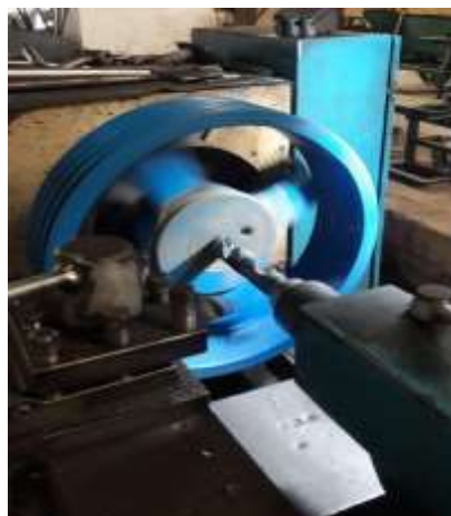
Gambar 8. Proses drilling pada pulley
