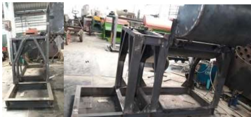
Gambar 6. Rangka yang telah melalui proses perakitan
