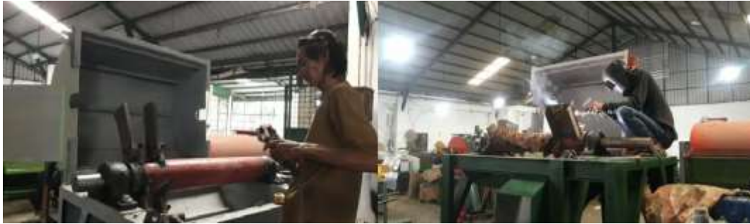
Gambar 7. Proses welding pada pemasangan mata pisau ke poros
