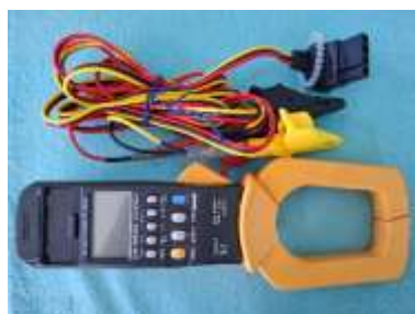
Gambar 4. Power Meter Sumber: Dokumentasi Pribadi (2025)
