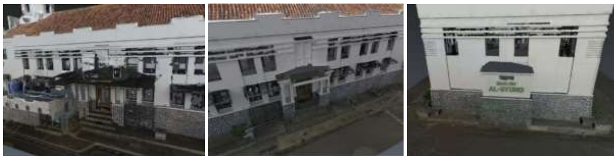
(a) (b) (c) Gambar 8. Area yang tidak terekam dengan baik oleh TLS dan UAV
