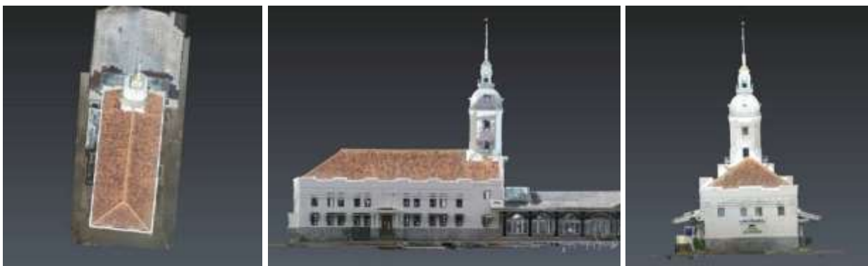
Gambar 6. Hasil integrasi point cloud tampak atas, tampak samping, dan tampak depan
