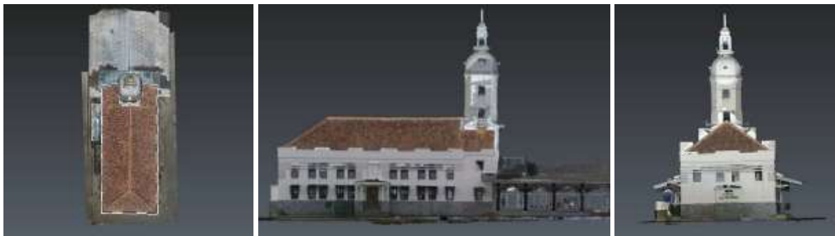
(a) (b) (c) Gambar 7 Hasil model 3D integrasi UAV dan TLS tampak atas, tampak samping, dan tampak depan
