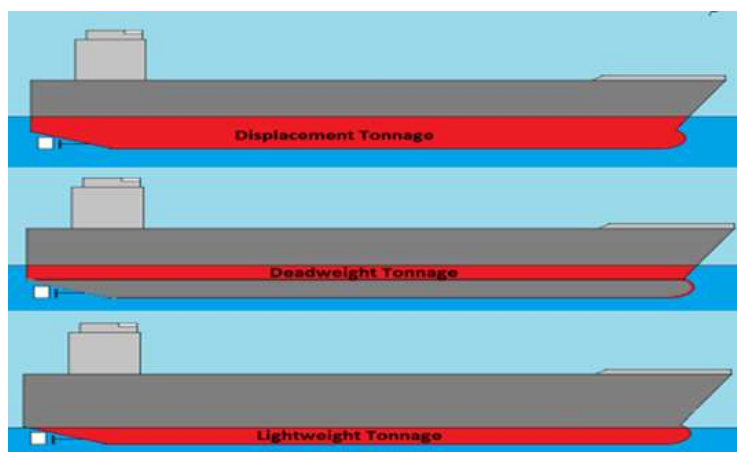
Gambar 2. Jenis berat tonnage pada kapal (displacement kapal) Sumber: Penelitian (2025)
