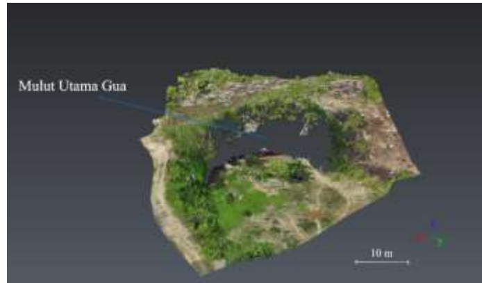
Gambar 6. Proses Foto udara menjadi Point Clouds
