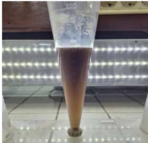
Gambar 1. Warna air limbah limpasan batubara sebelum pengolahan
