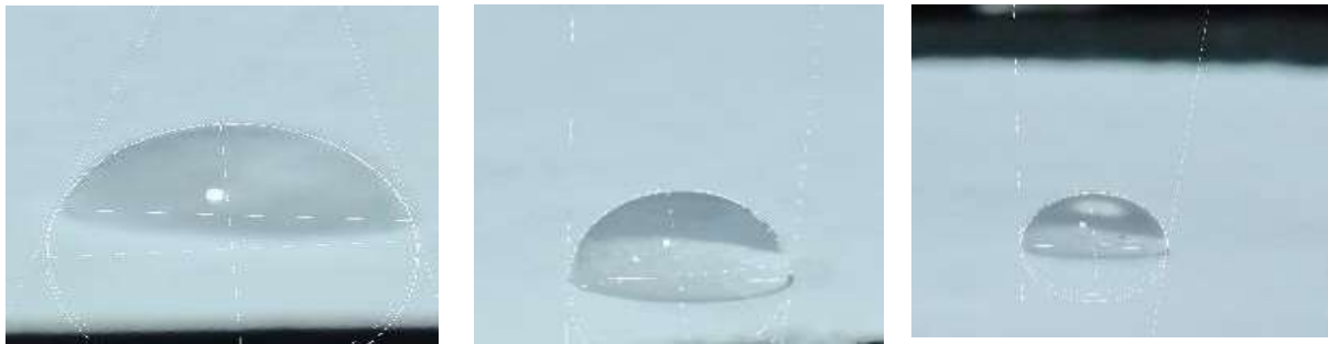
Gambar 4. Analisa sudut kontak menggunakan imageJ (a). Siklus-1 65% (b/v) konsentrasi membran; (b) siklus-2 65% (b/v) konsentrasi membran; (c) siklus-3 65% (b/v) konsentrasi membran
