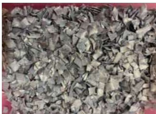
Gambar 1. Lempeng Seng Limbah Baterai Zn-C
