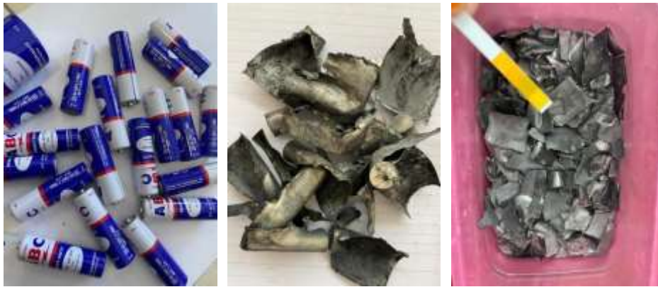
Gambar 1. (a) Limbah Baterai; (b) Lempeng Zn; (c) Potongan Lempeng Zn
