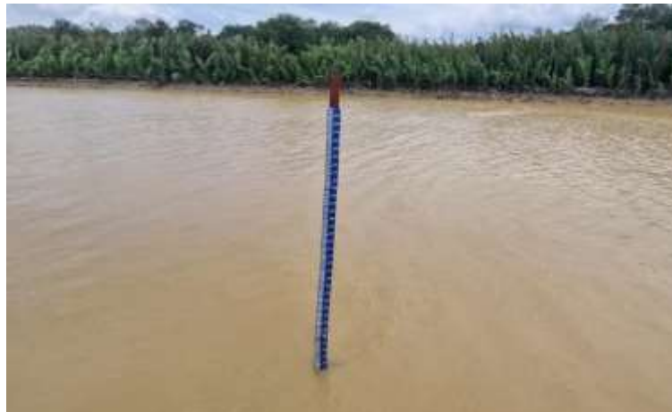
Gambar 3. Pemasangan Rambu Pasang Surut
