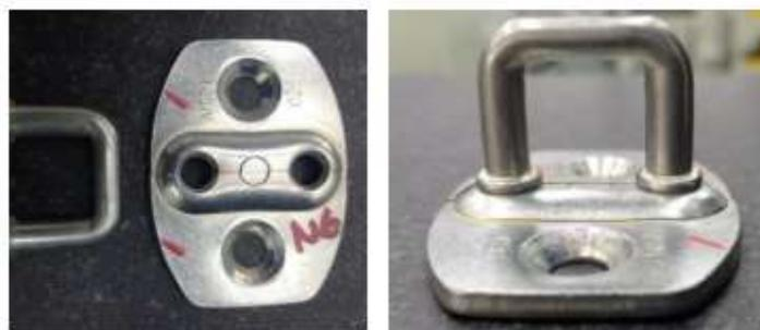
**Gambar 1.** Komponen *door lock* yang akan diwelding
