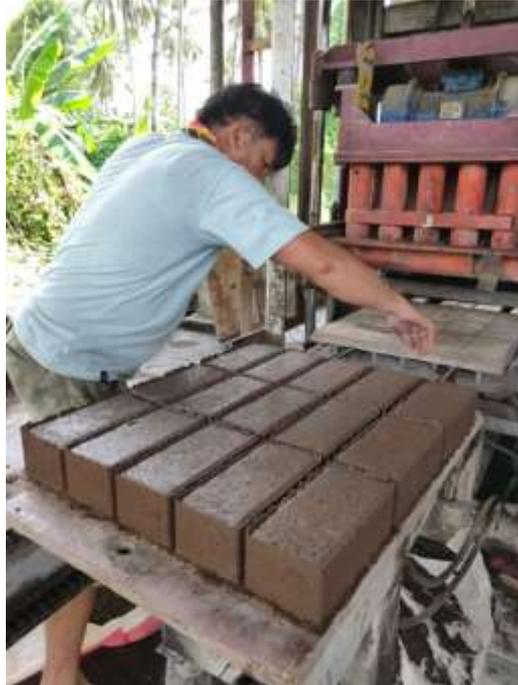
**Gambar 1.** Pembuatan dan pencetakan paving blok geopolimer dengan mesin cetak paving
