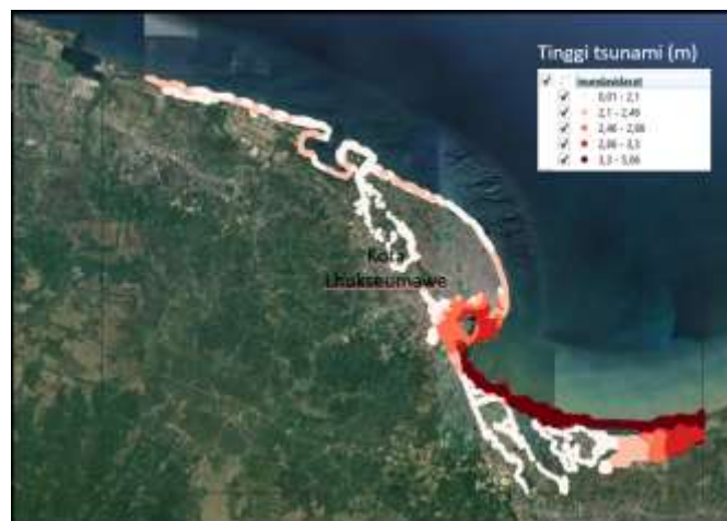
Gambar 5. Peta Tinggi tsunami dan area inundasi untuk skenario gempa 9.2 Mw dengan latar belakang foto udara
