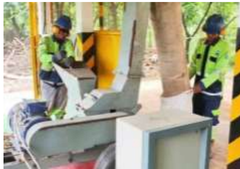
Gambar 6. Mesin pencacah kapasitas 2 ton/jam
