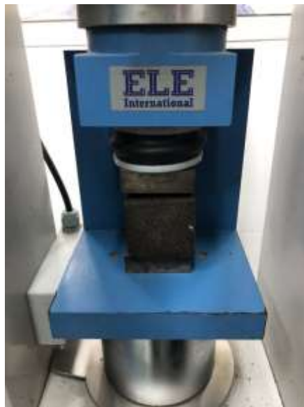
Gambar 12. Pengujian Benda Uji Kubus Geopolimer RHA Dengan Mesin Kuat Tekan
