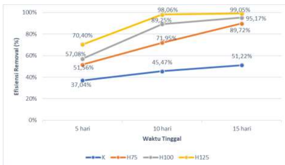
Gambar 2. Efisiensi Removal \text{Cu}^{2+} Berdasarkan Perlakuan Kontrol dan Berat Hydrilla verticillata pada Waktu Tinggal 5, 10, dan 15 Hari
