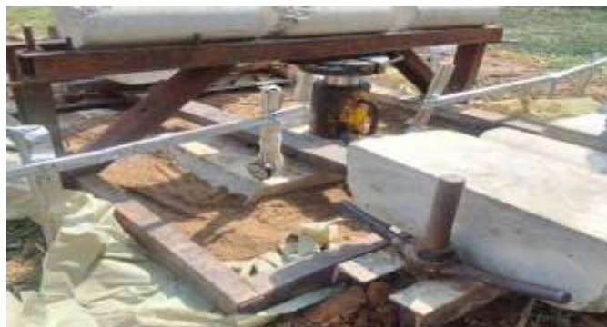
Gambar 7. Pengujian Eksperimental Pelat Beton Bersirip Sumber: Hasil Analisis (2025)
