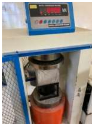
Gambar 1. Pengujian Kuat Tekan
