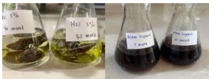
Gambar 3. Proses reduksi scale menggunakan pereduksi asam organik dan HCl
