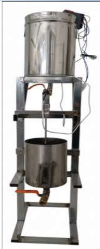
Gambar 3. Prototipe Dekanter Elektrokoagulasi yang Telah Dirakit
