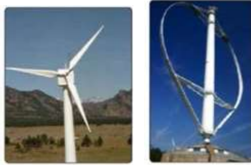
Gambar 2. Turbin angin sumbu horizontal dan vertikal [21]
