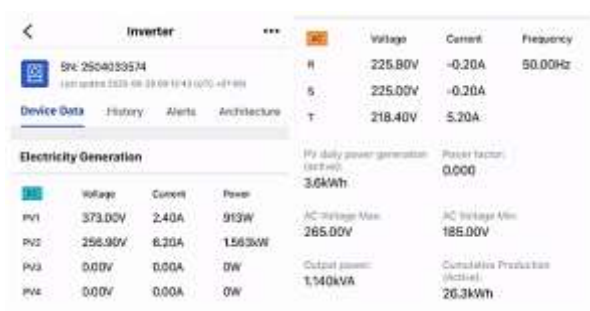
Gambar 10. Hasil Pengukuran PV dan Luar Inverter
