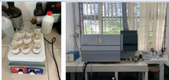
Gambar 1: Proses Destruksi dan Analisis As menggunakan ICP-OES
