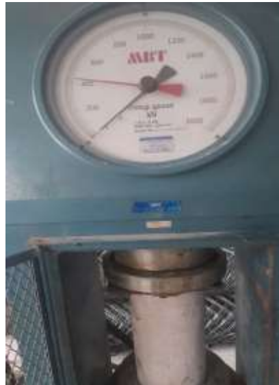
Gambar 3. Proses Pengujian Kuat Tekan Beton
