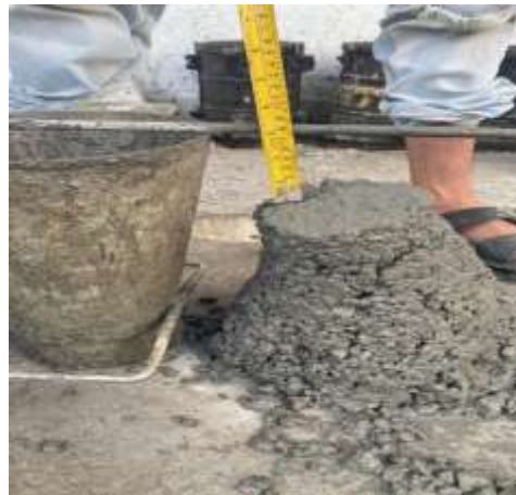
Gambar 2. Pemeriksaan Nilai Slump Test
