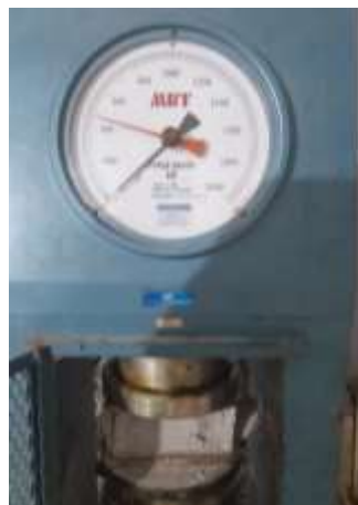
Gambar 2. Alat uji kuat tekan beton
