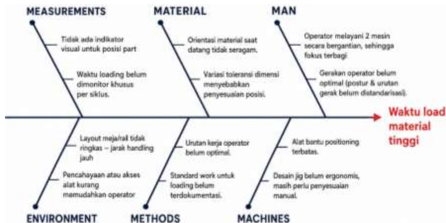
Gambar 3: Fishbone Diagram Penyebab Tingginya Waktu Loading Material
