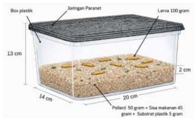
Gambar 1. Desain Reaktor Pemeliharaan Larva dan Media Limbah Plastik Sumber: Hasil Penelitian (2026)
