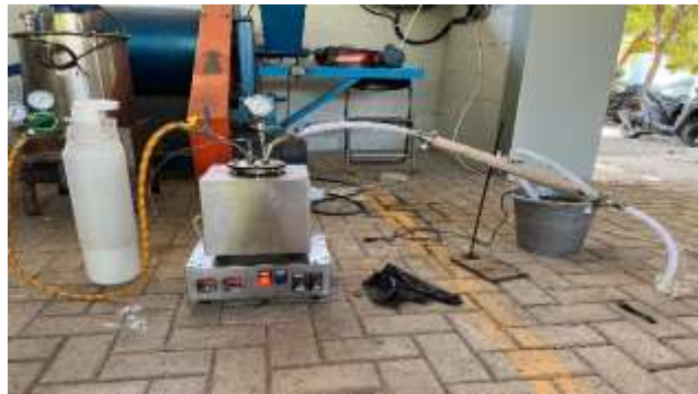
Gambar 2: Reaktor Pirolisis Sumber: Hasil Survey, 2026
