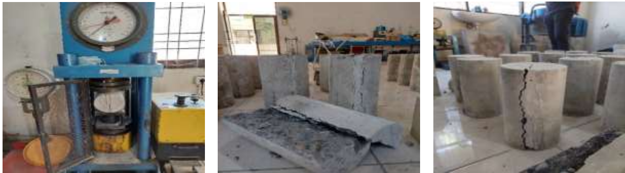
Gambar 6 : Kehancuran benda uji akibat pengujian kuat tarik beton Sumber : Penulis (2024)
