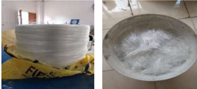
(a) Gulungan serat roving (b) Serat roving yang sudah dipotong
