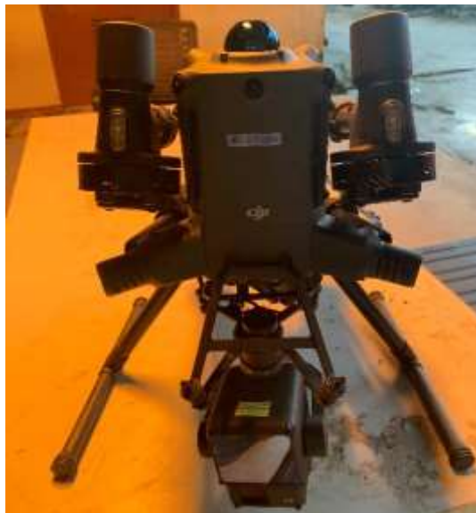
Gambar 5. UAV DJI Matrice 400 dan sensor LiDAR DJI Zenmuse L2.
