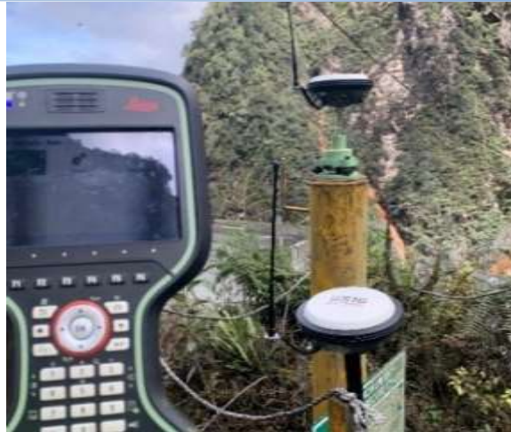
Gambar 4. Pengukuran GCP dan ICP menggunakan GNSS RTK Leica Viva GS16.
