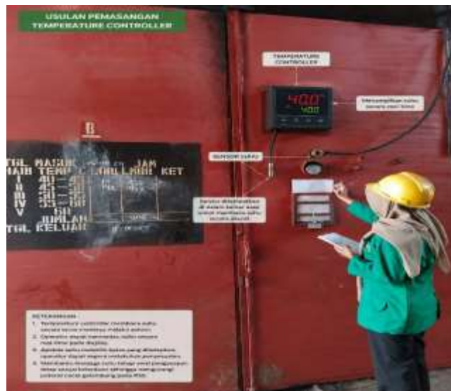
Gambar 7. Usulan Pemasangan Temperature Controller pada Proses Pengasapan RSS Sumber : Pengolahan Data, 2026
