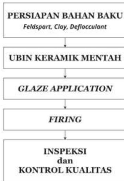
**Gambar 1.** Diagram Alir Proses Produksi Keramik PT X
