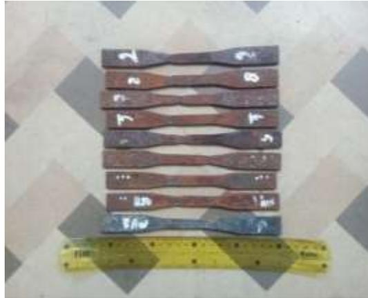
**Gambar 8.** Hasil spesimen pengujian tarik
