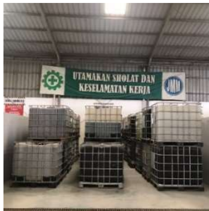
Gambar 3. Kemasan limbah B3 yang tidak dilekati simbol dan label limbah B3
