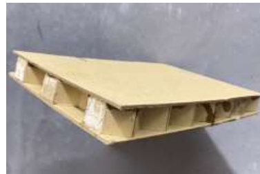
Gambar 16. Menyatukan skin bagian atas Sumber: Analisa data pada lapangan
