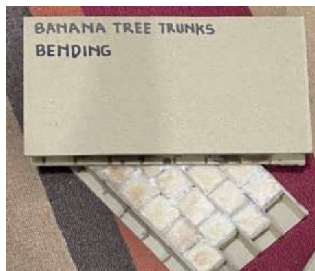
Gambar 17. Hasil Pembuatan Spesimen Sandwich Panel Struktur Sumber: Analisa data pada lapangan
