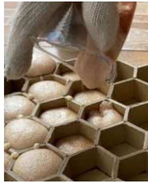
Gambar 15. Melumuri polymeric foam di bagian dalam dari struktur sandwich panel Sumber: Analisa data pada lapangan
