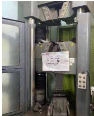
Gambar 2. Mesin uji bending Sumber: Analisa data pada lapangan
