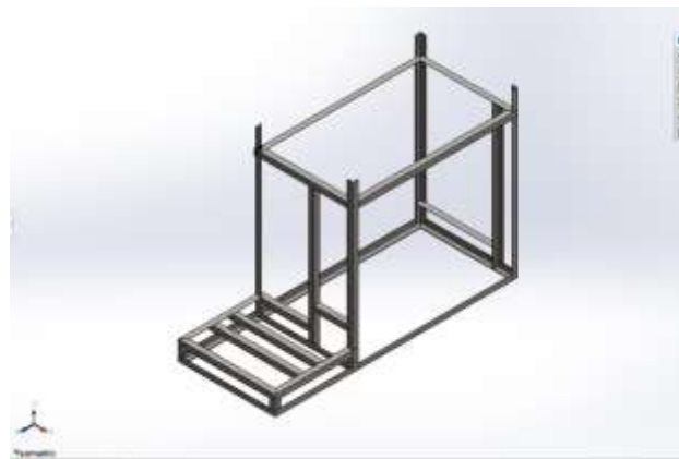
Gambar 3. Rangka mesin perontok padi Sumber: Analisa data pada software
