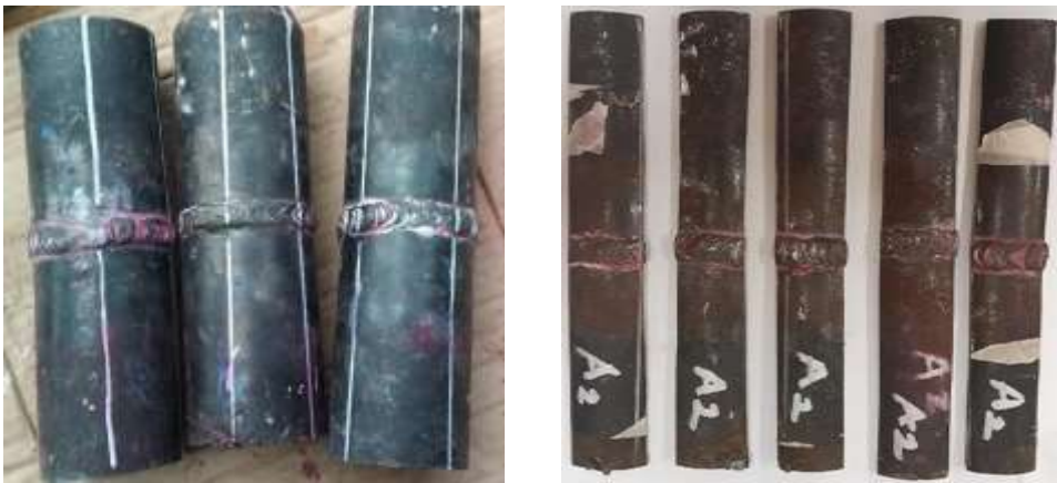
Gambar 10. Spesiment sebelum dipotong dan spesimen setelah dipotong Sumber: Analisa data pada lapangan
