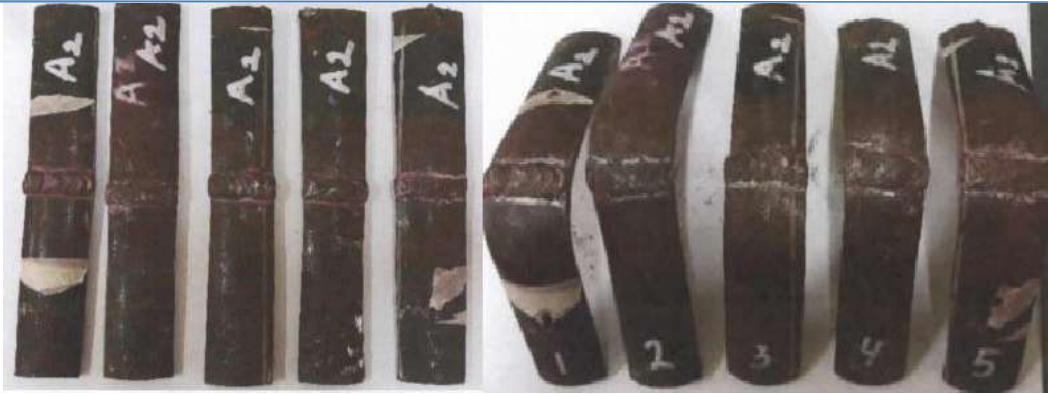
Gambar 12. Spesimen uji A.2 sebelum dan sesudah pengujian bending Sumber: Analisa data pada lapangan
