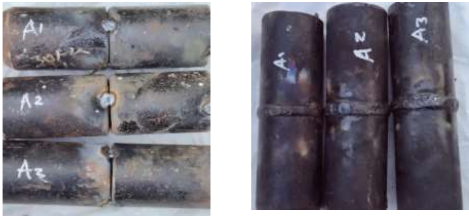
Gambar 8. Hasil Spesimen sebelum di las dan spesimen sesudah di las Sumber: Analisa data pada lapangan
