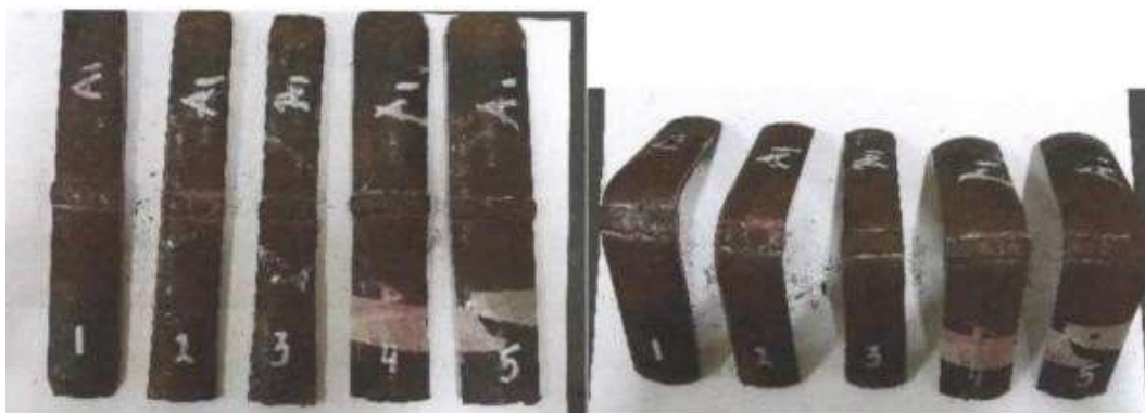
Gambar 11. Speciment Uji A.1 sebelum dan sesudah pengujian bending Sumber: Analisa data pada lapangan
