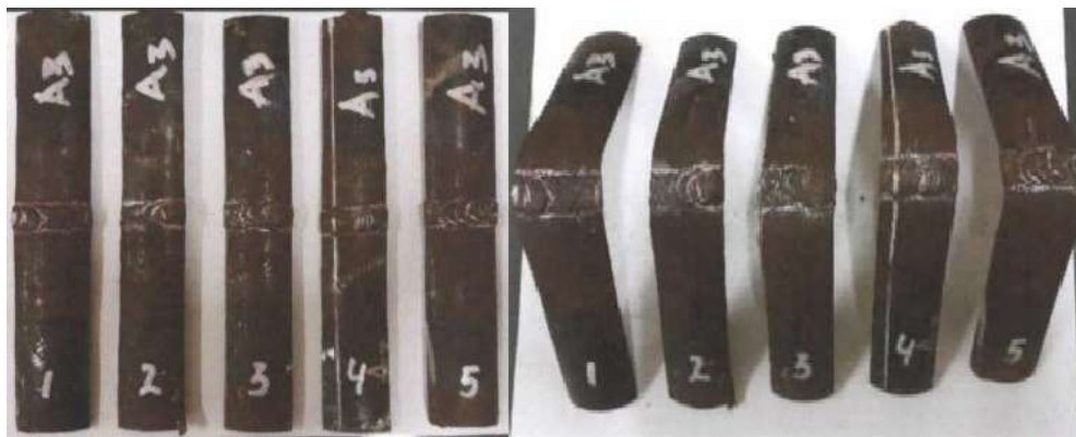
Gambar 13. Spesimen uji A.3 sebelum dan sesudah pengujian bending Sumber: Analisa data pada lapangan
