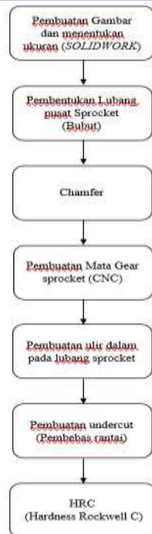
Gambar 4. Alur proses pembuatan sprocket Sumber: Analisa data pada lapangan
