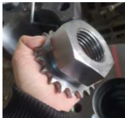
Gambar 8. Hasil ulir dalam lubang sprocket Sumber: Analisa data pada lapangan
