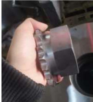
Gambar 9. Hasil proses undercut (pembebas rantai) Sumber: Analisa data pada lapangan
