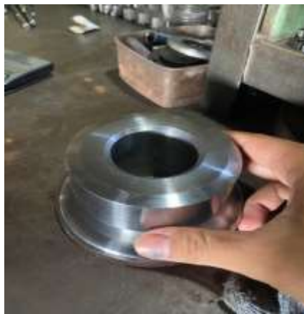
Gambar 6. Hasil pembentukan lubang pada sprocket Sumber: Analisa data pada lapangan
