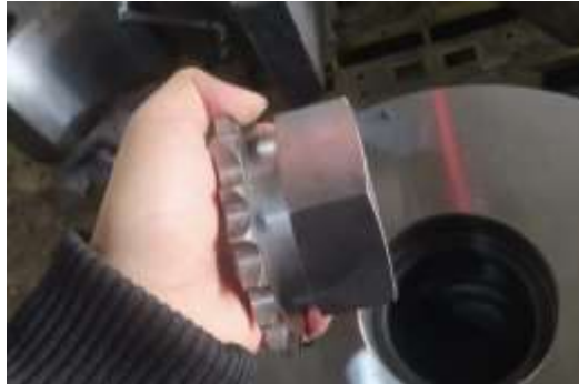
Gambar 7. Hasil pembuatan mata gear Sumber: Analisa data pada lapangan
