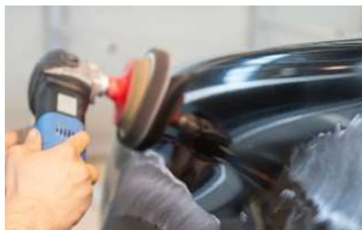
Gambar 8. Proses polish repair Sumber: Analisa data pada lapangan
