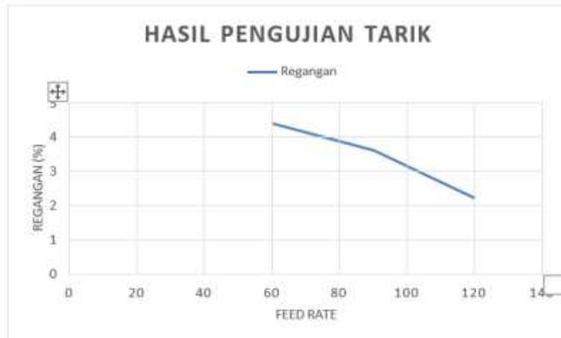
**Gambar 3.** Hasil perbandingan pengujian regangan dengan *feed rate*
