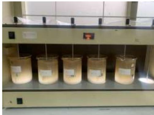
**Gambar 2:** Pengolahan air limbah menggunakan metode jar test
