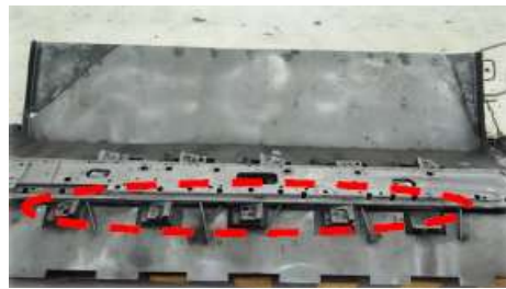
Gambar 2. Defect Burry pada Dies op-20 proses trimming/piercing
