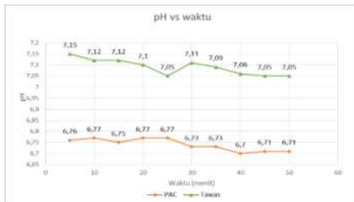
Gambar 3. Hubungan pH dengan Waktu pada Koagulan PAC dan Tawas dengan pengadukan cepat 150 rpm
