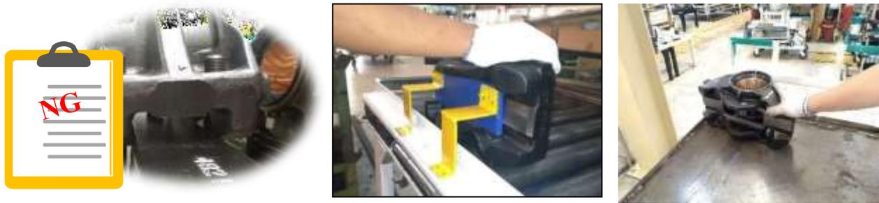
**Gambar 2.** Hasil barang NG, lalu di bantu dengan alat *Go Nogo JIG Dummy*, dan produk OK
